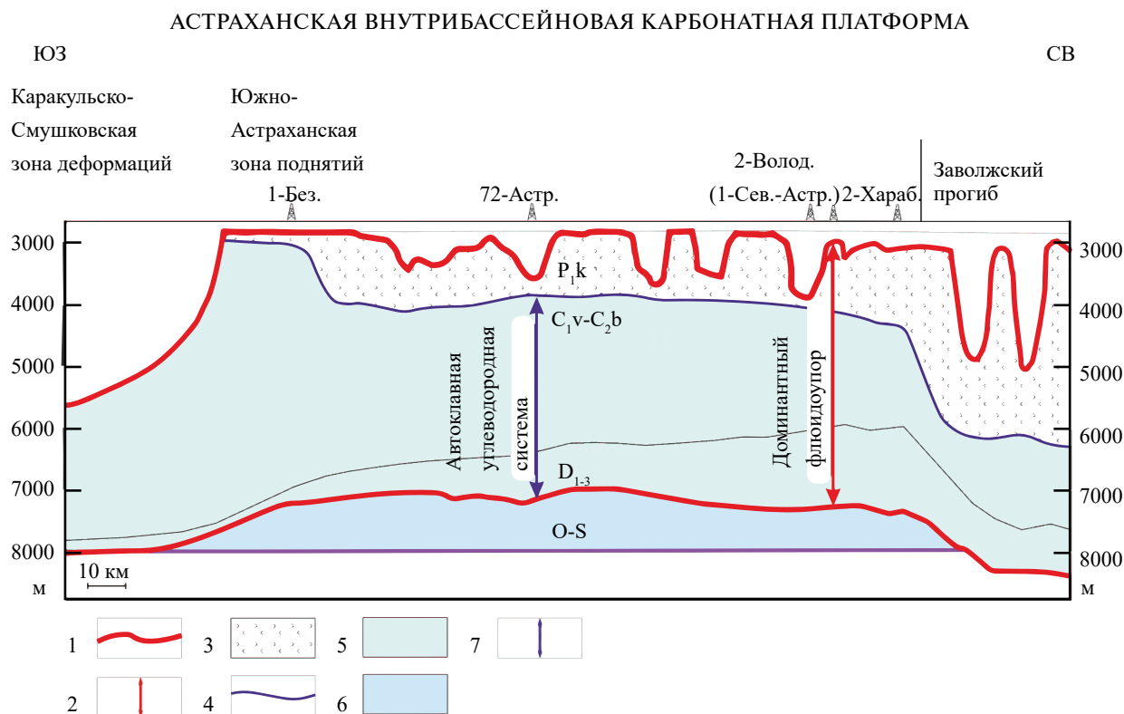
Рис. 5. Геофлюидодинамическая модель Астраханской платформы, в пределах которой возможно размещение научно-технологического полигона. Доминантный флюидоупор: 1 – границы, 2 – область распространения (мощность 4–8 км); 3 – соленосная толща мощностью 3–6 км; 4 – сульфатно-карбонатно-глинистый горизонт в основании соленосной толщи; автоклавная углеводородная система: 5 – область распространения, 6 – мощность 4–8 км; 7 – область потенциального водоронакопления
